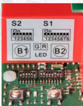
Handbetätigung mit Taster oder Handrad. Parametriermöglichkeit mit DIP-Schalter
