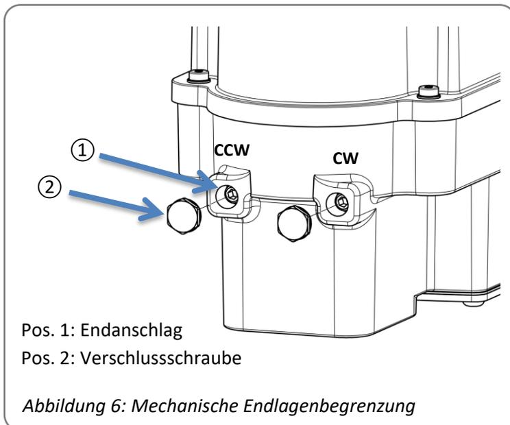
Zur Begrenzung des Antriebsschwenkwinkels stehen zwei einstellbare mechanische Endanschläge zur Verfügung. Hierzu zunächst die Verschluss-schrauben lösen und die darunter liegenden Endanschläge verstellen. Danach die Verschluss-schrauben wieder montieren, Anzugdrehmoment 2 Nm.
