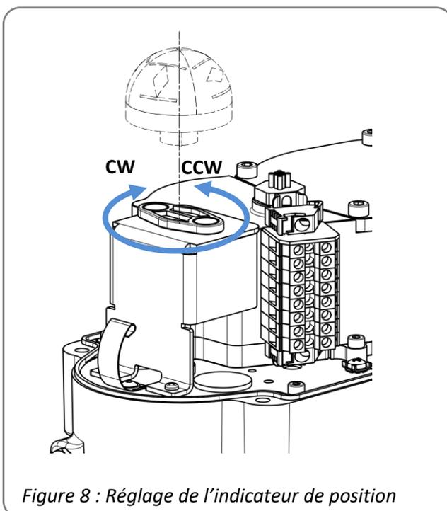
Figure 8 : Réglage de l'indicateur de position
