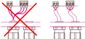
**Alle Netzanschluss- und Steuerleitungen müssen mechanisch durch geeignete Maßnahmen vor den Anschlussklemmen gegen unabsichtliches Lösen gesichert werden.**
