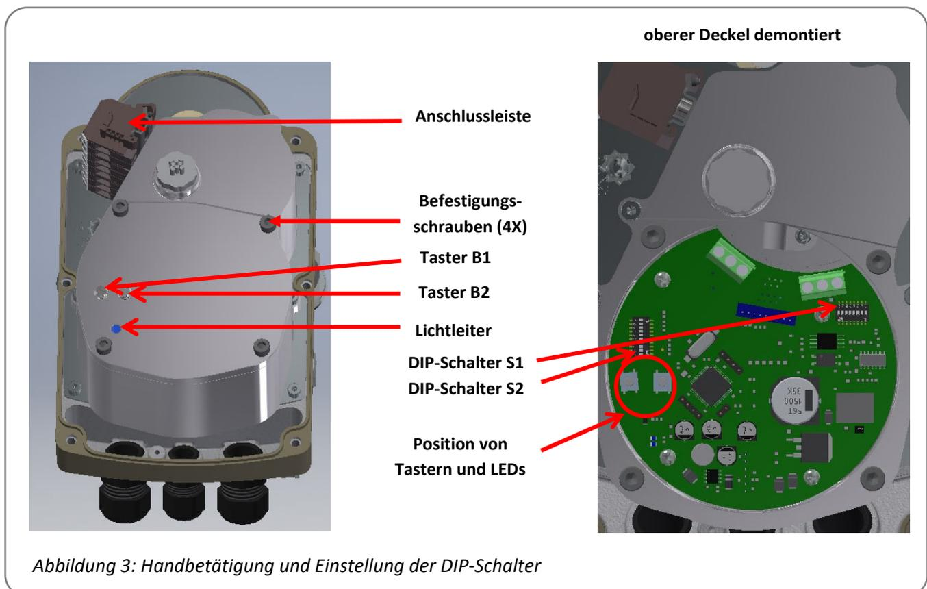
Abbildung 3: Handbetätigung und Einstellung der DIP-Schalter
