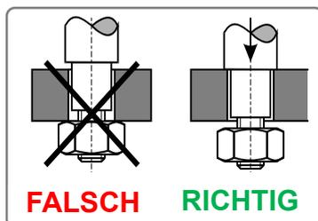
**Vor dem Anziehen der Befestigungsmutter müssen die Säulen auf der Ventiltraverse aufsitzen. Gegebenenfalls ist die Stellung des Antriebes über die Handbetätigung zu korrigieren. Bei Nichtbeachtung: Beschädigung des Antriebs!**
