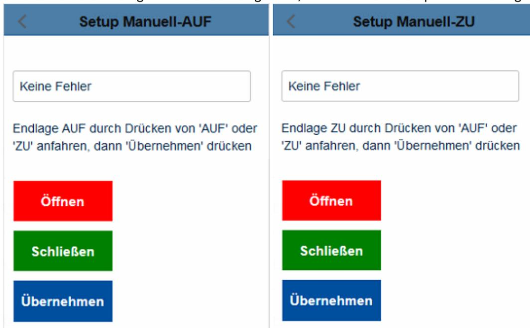
Info: Die Position Endlage, die beim automatischen Ventilabgleich über den Winkel berechnet wurde, kann mit dieser Einstellung verändert werden. Der Winkel wird anschließend neu berechnet.
