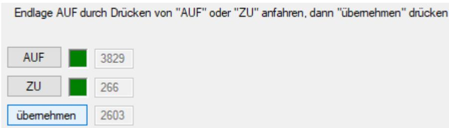
Info: Die Position Endlage, die beim automatischen Ventilabgleich über den Winkel berechnet wurde, kann mit dieser Einstellung verändert werden. Der Winkel wird anschließend neu berechnet.
