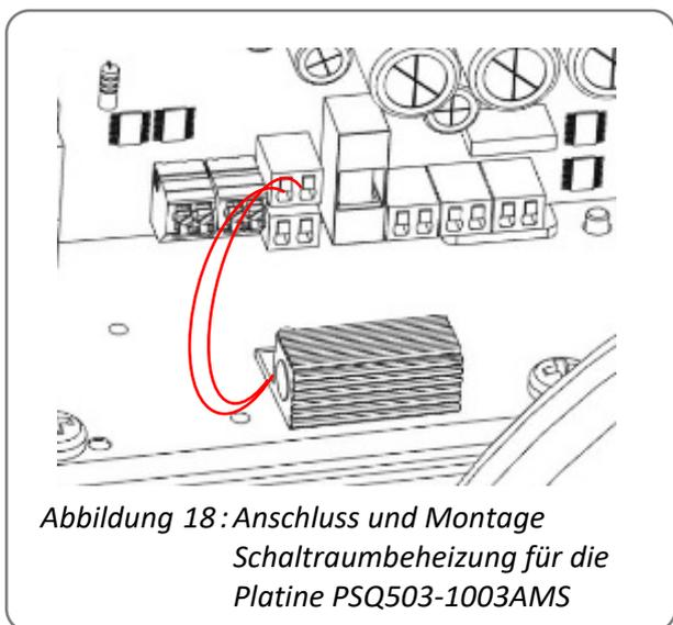
Abbildung 18: Anschluss und Montage
