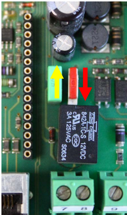
Abbildung 3 Schiebeschalter zur Schnittstellenwahl
