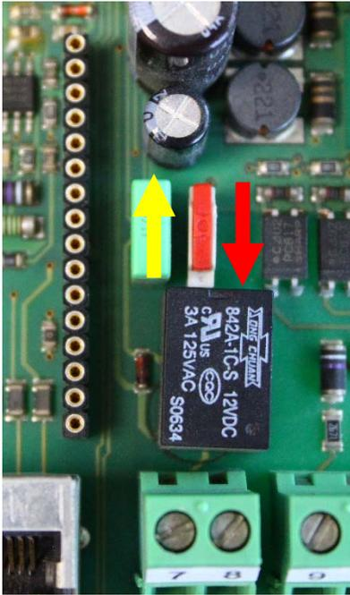
Auf der Leiterplatte im Antriebsinnenraum befindet sich ein Schiebeschalter zur Auswahl der Schnittstelle, siehe Abbildung 3 Schiebeschalter zur Schnittstellenwahl.
