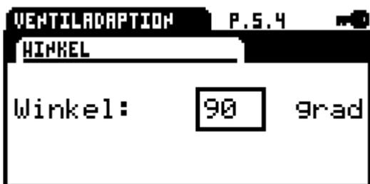
**Info:** Bei der automatischen Inbetriebnahme mit zwei Drehmoment-Endlagen wird dieser Wert durch den Antrieb errechnet.
