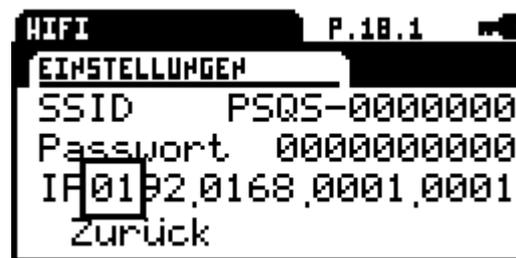
SSID: SSID des Funknetzes vom Antrieb
