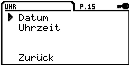
Die Uhr ist batteriegepuffert und läuft auch während eines Netzausfalls weiter.
