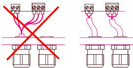
Alle Netzanschluss- und Steuerleitungen müssen mechanisch durch geeignete Maßnahmen vor den Anschlussklemmen gegen unabsichtliches Lösen gesichert werden. Netzanschluss und Steuerleitungen dürfen nicht zusammen in einer Leitung geführt werden, es sind stets zwei getrennte Leitungen zu verwenden!
