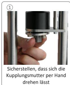
Sicherstellen, dass sich die Kupplungsmutter per Hand drehen lässt
