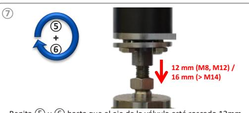
Repita ⑤ y ⑥ hasta que el eje de la válvula esté roscado 12mm (en caso de M8 hasta M12) o 16mm (en caso de M14 o superior)
