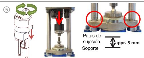
Cierre manualmente el actuador hasta que encaje con el eje de la válvula. Continúe cerrando hasta que se tenga un espacio de 5mm entre las patas de sujeción y el soporte
