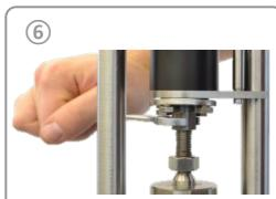
Apriete el acoplamiento hasta que las patas de sujeción entren en contacto con el soporte de la válvula
