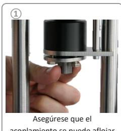
Asegúrese que el acoplamiento se puede aflojar a mano
