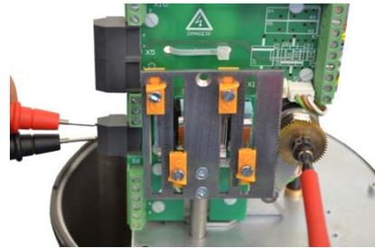
Messgerät anschließen und Potentiometer via Rutschkupplung auf den gewünschten Wert der aktuellen Antriehsposition einstellen (bei PSAP/PSPT entsprechende Anleitung verwenden); anschließend Leitungsanschluss durchführen / Connect indicator and set the potentiometer to the required value of the active actuator position via the friction clutch (for PSAP/ PSPT see respective instruction); afterwards, connect cable
