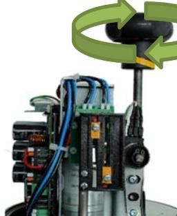
Antrieb per Handrad verfahren und Positionen der Schaltnocken überprüfen
