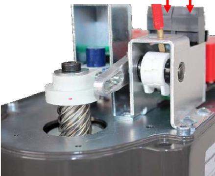
Die Endscharter als Öffner / Schließer anschließen. Die Spannungsversorgung wiederherstellen. Den Antrieb im Handmodus verfahren, bis die gewünschte Schaltposition erreicht ist. Die Schaltnocken mit einem Schraubendreher (Klingenbreite 4 mm) verdrehen bis die Mikroswitcher hörbar klicken. Die Funktionsrichtung „Extend“ (ausfahrend) bzw. „Retract“ (einfahrend) bezieht sich auf die Antriebsspindel.
