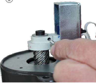
Den Kugelbolzen mit einem Gabelschlüssel (Größe 5,5) in die Bohrung im Magnethalter einschrauben.
