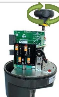
Antrieb per Hand verfahren und Schaltnocken
