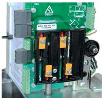
Zusatzwegschanter gem. Schaltplan anschließen /
